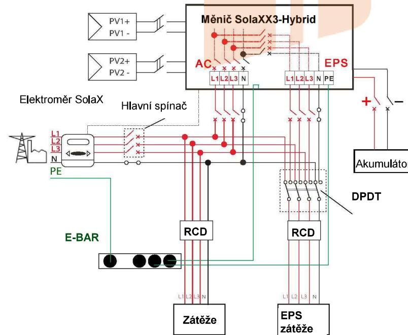
**Schéma B** platí pro předpisy pro elektrické zapojení, které vyžadují že nulový vodič alternativního napájení nesmí být odpojený nebo vypnuty, (platí pro předpisy pro elektrické zapojení AS/NZS\_3000:2012 pro Austrálii a Nový Zéland)
